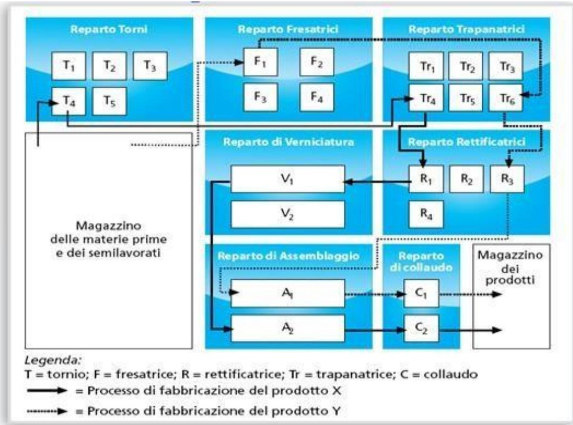
Layout delle macchine per reparto: schema esemplificativo di uno stabilimento meccanico. (Le macchine sono disposte in gruppi funzionali: il singolo lotto di pezzi segue il percorso prestabilito. A titolo indicativo sono tracciati i percorsi dei due prodotti X e Y: essi si muovono da un reparto all'altro in lotti e vengono depositati temporaneamente a ogni stazione di lavoro in attesa del loro turno)
