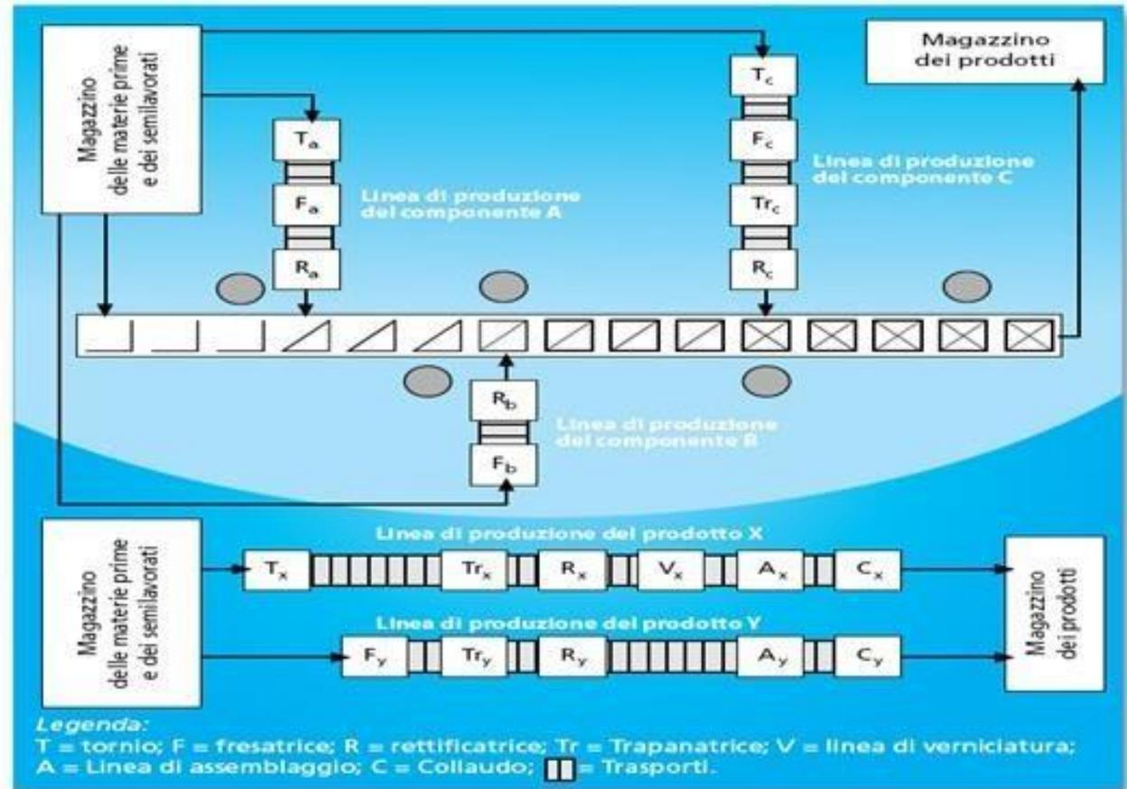
Layout delle macchine a catena: schemi esemplificativi di due stabilimenti. (Le macchine sono specializzate e disposte in base alla sequenza tecnologica delle operazioni richieste per la fabbricazione e per l'assemblaggio; il movimento dei pezzi è continuo.)
